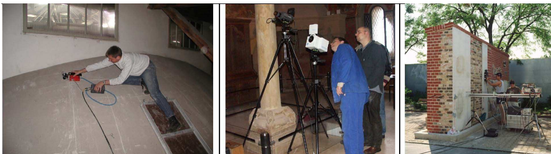
Figura 7: algunos ejemplos de ensayos no destructivos de monumentos históricos, fuente http://precomos.org/images/uploads/library_items/NDT_SPRECOMAH.pdf
